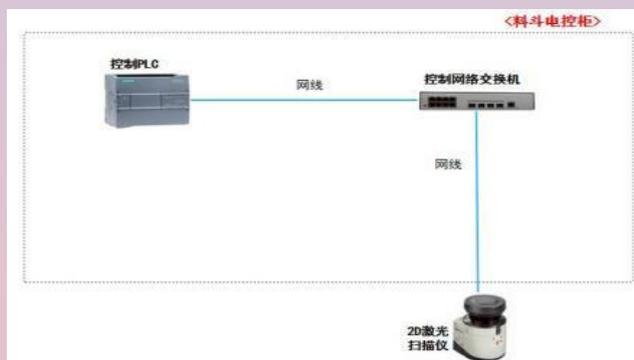
车厢检测系统主要功能包括测量出卡车前后和左右方向的位置偏差，检测卡车是否进入料斗及卡车是否在安全位置。
