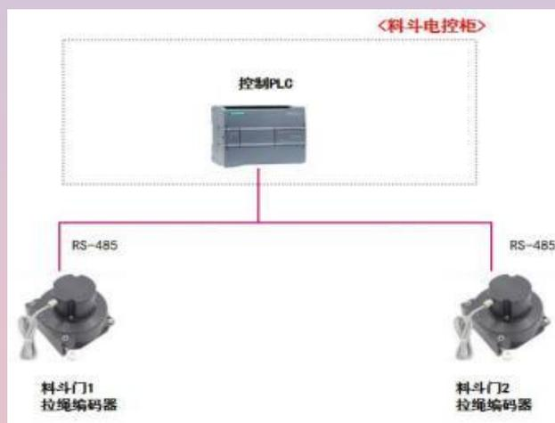
每个料斗门分别由一台电液推杆来驱动，因此要测出料斗门的开度，只需要测量出推杆伸出的长度即可。因此在每个电液推杆处分别安装一个拉绳编码器，当推杆伸出时拉动钢丝绳并带动编码器的转动，从而测量出编码器的旋转脉冲数，通过换算即可得到推杆伸出的长度。拉绳编码器可以通过 RS485 或模拟量信号输出
