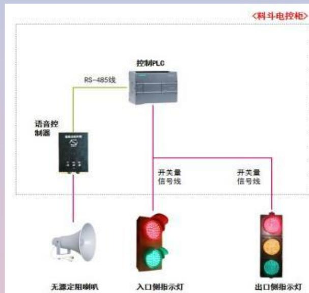
声光提示系统是通过指示灯和声音相结合的方式提醒货车司机进行相关的操作。其中在车辆入口处安装红绿两色指示灯，由PLC 输出开关量信号进行控制，显示为绿灯表示货车可以进斗装车，红灯表示系统有故障需要复位或者料斗下方有障碍物，货车不能进斗装车。
